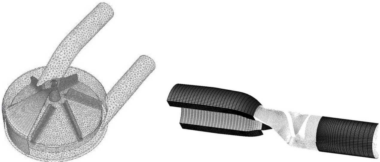
Abbildung 4 Diskretisiertes Modell einer Zentrifugalpumpe (links) [1]
