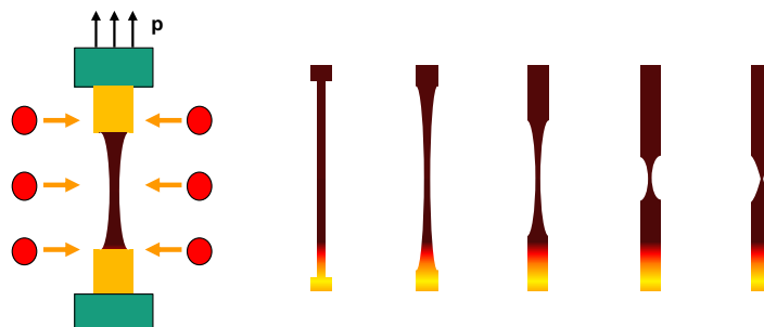
Abbildung 3 Glasfaser Ziehprozess und Profilvariant
